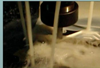
Usinage sur une fraiseuse 3 axes grâce au programme issu de la F.A.O.
