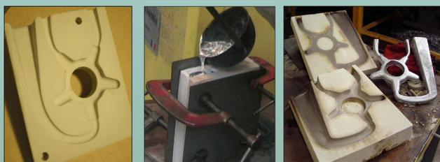
Prototypage du moule en céramique et essai de coulée
