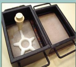
Préparation et réalisation des moules en sable
