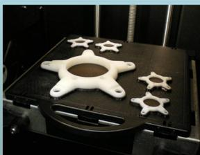
Réalisation à partir du modèle 3D d'une pièce prototype permettant notamment de vérifier son intégration dans le système mécanique.
