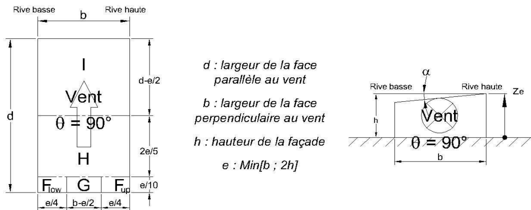
Schéma 4-2 bâtiment à 1 versant Décomposition des faces pour les parois inclinées
