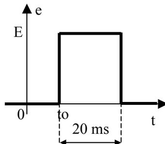
Soit le dipôle R.L série ci-contre alimenté par une source de tension  $e(t)$  produisant une impulsion de tension de largeur 20 ms et d'amplitude  $E$ , à partir de l'instant  $t_0$ .
