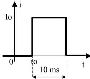
Soit le dipôle R.C série ci-contre alimenté par une source de courant  $i(t)$  produisant une impulsion de courant de largeur 10 ms et d'amplitude  $I_0 = 1 \text{ mA}$  à partir de l'instant  $t_0$ .
