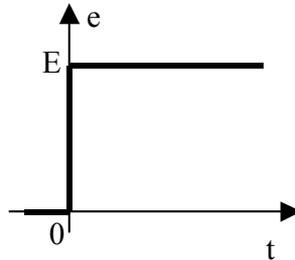
Soit le dipôle R.L série ci-contre alimenté par une source de tension  $e(t)$  produisant un échelon de tension  $E$  à partir de  $t = 0$ .
