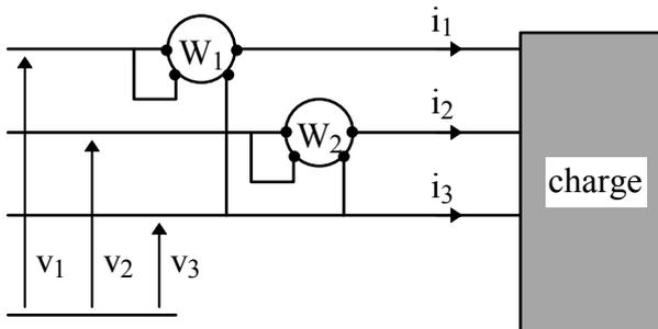
Ce montage déjà utilisé pour mesurer la puissance active lorsque le neutre n'est pas relié, permet également de mesurer la puissance réactive lorsque la ligne est en régime alternatif sinusoïdal triphasé équilibré en tensions et courants.
