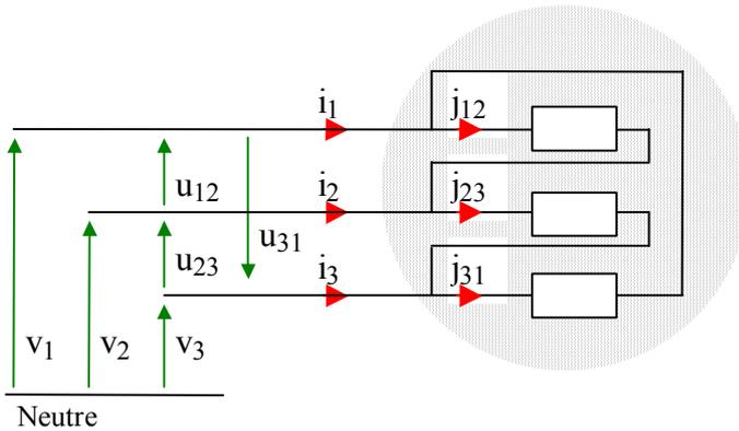
La ligne triphasée ci-contre alimente, sous tensions alternatives sinusoïdales triphasées équilibrées, un moteur qui absorbe des courants alternatifs sinusoïdaux triphasés équilibrés.
