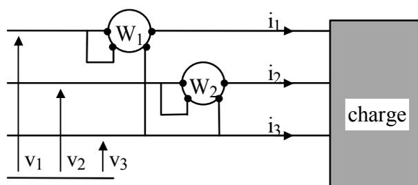
Dans ce cas on peut donc mesurer la puissance active transmise par une ligne triphasée (équilibrée ou non, avec des signaux sinusoïdaux ou non) à l'aide de deux wattmètres seulement.
