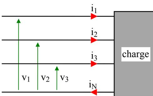
Cette ligne triphasée est soumise à des tensions  $v_1(t)$ ,  $v_2(t)$  et  $v_3(t)$ , et elle est parcourue par des courants  $i_1(t)$ ,  $i_2(t)$ ,  $i_3(t)$  et  $i_N(t)$  qu'elle délivre à une charge quelconque.
