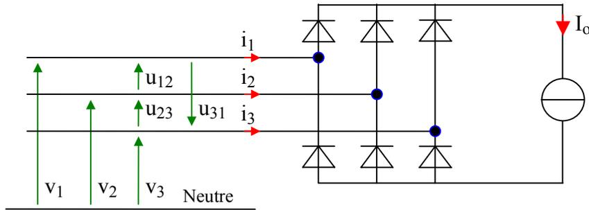
Dans la ligne d'alimentation du montage, les tensions sont alternatives sinusoïdales triphasées équilibrées ; les courants sont triphasés équilibrés, mais pas sinusoïdaux :
