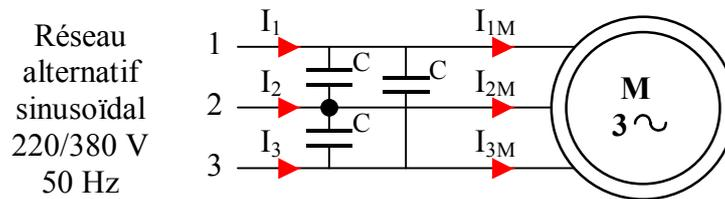
Dans le montage ci-dessus, le moteur triphasé se comporte en charge équilibrée inductive. Il restitue sur son arbre une puissance mécanique utile  $P_u = 15 \text{ kW}$ . Son rendement est  $\eta = 78\%$  <sup>(3)</sup>, et son facteur de puissance a pour valeur :  $\cos(\varphi) = 0,82$ .
