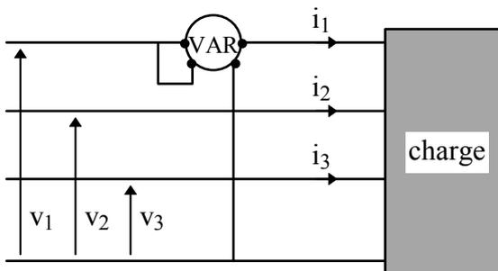
La puissance réactive véhiculée par la ligne est égale à trois fois la valeur indiquée par le varmètre.
