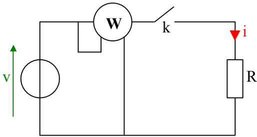
Une ligne monophasée alimente un gradateur sous une tension alternative sinusoïdale  $v(t)$  d'amplitude  $\hat{V}$ . (représentée ci-dessous).
