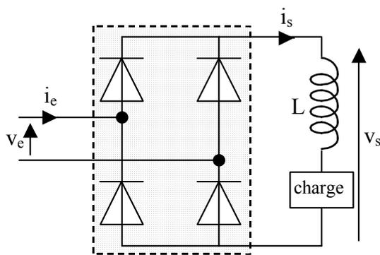
Un pont redresseur à diodes, alimenté sous une tension alternative sinusoïdale  $v_e(t)$  applique une tension redressée  $v_s(t)$  à une charge très inductive (4). En régime permanent, le courant  $i_s(t)$  est quasiment constant :  $i_s(t) \approx I_o = \text{constante}$ .
