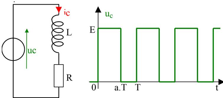
Un hacheur série applique à une résistance  $R$  en série avec une inductance  $L$ , la tension carrée  $u_c(t)$  d'amplitude «  $E$  » et de rapport cyclique «  $a$  ».
