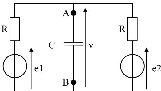
Sachant que  $e1(t) = 5.\cos(\omega.t)$ ,  $e2(t) = \text{constante} = 10V$  et que  $R = \frac{1}{C.\omega} = 100\Omega$ , déterminer  $v(t)$  en régime permanent.
