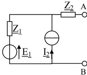
$e_1(t)$  et  $i_2(t)$  sont alternatifs sinusoïdaux de même fréquence.
