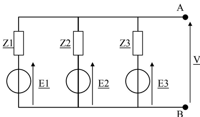
Calculer le courant de court-circuit complexe  $I_{cc}$  et l'impédance équivalente  $Z_{eq}$  du dipôle AB.
