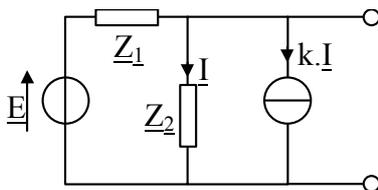
Sachant que  $k$  est une constante réelle différente de  $-1$ , déterminer le schéma équivalent de Thévenin de ce dipôle.
