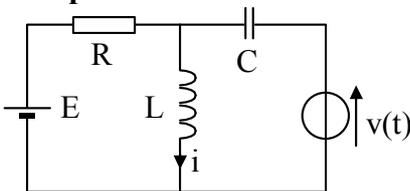
$v(t) = \hat{V} \cdot \cos(\omega t)$  ;  $E = \text{constante}$ . Exprimer  $i(t)$  en régime périodique en fonction des éléments du montage sachant que  $R = L \cdot \omega = \frac{1}{C \omega}$ .
