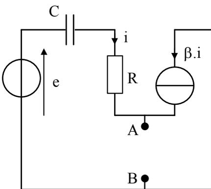
$E(t)$  est une source de tension alternative sinusoïdale d'amplitude  $\hat{E}$  et de pulsation  $\omega$  qui sera prise comme référence (origine des phases).
