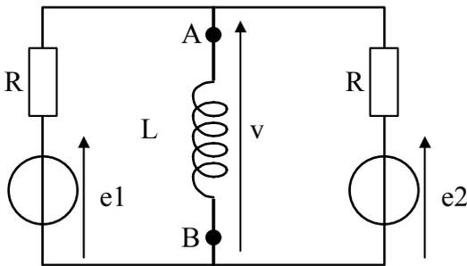
Sachant que  $e1(t) = 5.\cos(\omega.t)$ ,  $e2(t) = \text{constante} = 10V$  et que  $R = L.\omega = 100 \Omega$ , déterminer  $v(t)$  en régime permanent.
