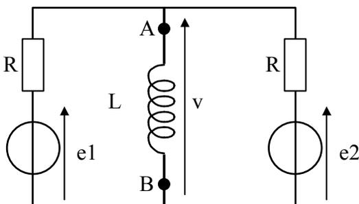
Sachant que  $e1(t) = 5.\cos(\omega.t)$ ,  $e2(t) = 5.\sin(\omega.t)$  et que  $R = L.\omega = 100 \Omega$ , déterminer  $v(t)$  en régime permanent en appliquant le théorème de superposition.
