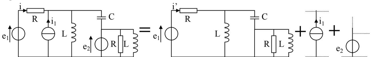
$i'(t)$  est la composante de  $i(t)$  engendrée par la source  $e_1(t)$  seule. Si  $i(t)$  ne dépend pas de  $e_1(t)$ , alors  $i'(t) = 0$
