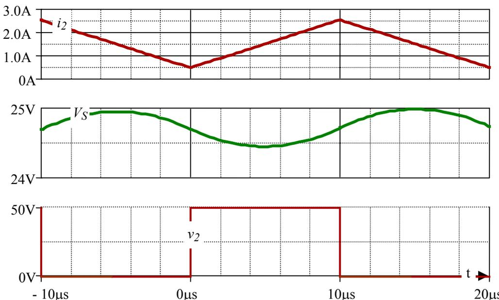
*On remarque que la simulation informatique prend en compte la tension de seuil de la diode, ce qui engendre une diminution de  $V_S(t)$  (qui n'est plus centré sur 25 V)*
