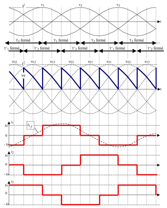
**b)** On constate que déphasage  $\varphi$  de  $v_1(t)$  par rapport au fondamental  $i_1$  (t) de  $i_1(t)$  correspond à deux divisions. La tension est en avance par rapport au fondamental du courant. Donc  $\varphi = \frac{\pi}{3}$
