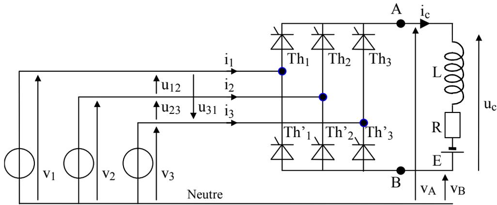
La conduction est continue dans la charge avec un angle de retard à l'amorçage est de 150°.
