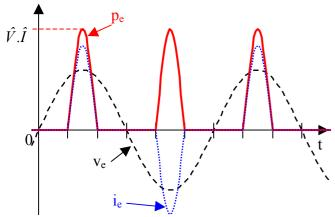
Lorsque  $i_e(t) = 0$ , la puissance instantanée est nulle. Lorsque  $i_e(t) > 0$  et  $v_e(t) > 0$ , la puissance instantanée est positive. Lorsque  $i_e(t) < 0$  et  $v_e(t) < 0$ , la puissance instantanée est encore positive.
