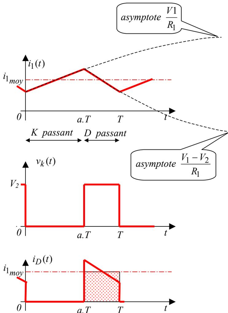
b) Sur l'intervalle où « K » est fermé (de durée  $a.T$ ), le courant  $i_1(t)$  est déterminé par l'équation différentielle du 1<sup>er</sup> ordre à second membre constant:  $L \cdot \frac{d(i_1(t))}{dt} + R_1 \cdot i_1(t) = V_1$ . Le graphe de  $i_1(t)$  est une exponentielle décroissante d'asymptote  $\frac{V_1}{R_1}$ . Mais sachant que la durée  $a.T$  est très inférieure à la constante de temps  $L/R_1$ ,  $i_1(t)$  peut être approximé, sur cet intervalle, par un segment de droite.
