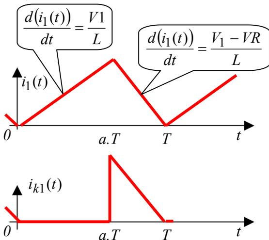
**B -b)** La conduction est continue si le courant  $I_{1\text{min}}$  de la question précédente est supérieur à zéro (sinon la diode  $k_1$  se bloque dès que le courant  $i_{k1}(t)$  est nul).
