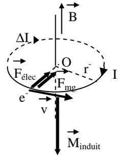
L'électron est soumis en plus à la force magnétique :  $\vec{F}_{\text{mg}} = -e \cdot \vec{v} \wedge \vec{B}$   $\vec{F}_{\text{mg}}$   $\left\{ \begin{array}{l} \text{direction : } \perp \text{ à } (\vec{v} \text{ et } \vec{B}) \Rightarrow \perp \text{ au mouvement} \\ \text{sens : règle 3 doigts main droite } \Rightarrow \text{ centripète} \\ F = e \cdot v \cdot B \end{array} \right.$
