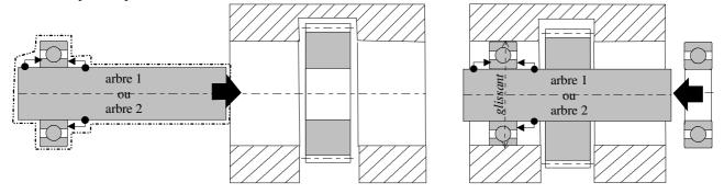
Un roulement doit être monté en même temps sur l'arbre et l'alésage. L'ajustement initialement serré entre l'arbre et la bague intérieure risque de rendre ce montage délicat. On peut le remplacer par un ajustement glissant.
