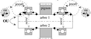
$2^{\circ}$  assurer la mise en position *radiale* (ajustements glissants) de l'ensemble "arbre + 2 roulements" dans le logement
