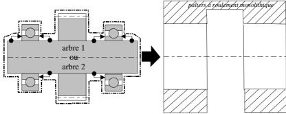
Ce montage est *habituellement impossible* compte tenu de l'encombrement radial important du pignon (sauf pour les cas de carter-logement en deux parties ou d'utilisation de boites à roulements - impératif pour pignon arbré-, ou pour un roulement de diamètre extérieur supérieur au diamètre extérieur de la prise de mouvement). Il faut alors définir un ordre de montage différent ne respectant pas la démarche initiale :
