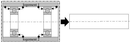
3° assurer la mise en position axiale, ♠, (et éventuellement le maintien en position, ♠) de l'ensemble "logement + 2 roulements" sur l'arbre (3 configurations possibles)
