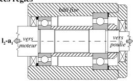
*Remarque*: utiliser les dispositifs de maintien en position sur l'arbre **et** dans le logement plus particulièrement:
