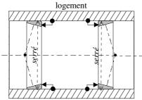
$2^{\circ}$  assurer les mises en position *radiales* (ajustements glissants) des 2 "cônes + cages" sur l'arbre ainsi que celle de l'ensemble "logement+2 cuvettes"
