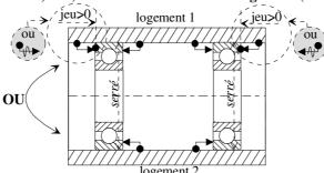
$2^{\circ}$  assurer la mise en position radiale (ajustements glissants) de l'ensemble "logement + 2 roulements" sur l'arbre
