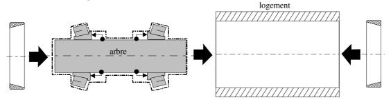
$3^{\circ}$  assurer les mises en position *axiales*,  $\bullet^{\blacktriangleright}$ , des 2 cuvettes dans le logement ainsi que celle de l'ensemble "arbre+2 (cônes + cages)" et régler à l'extérieur du montage le *jeu* de fonctionnement (ou la *précontrainte*) sur la grande face d'une cuvette,  $\bullet^{\diamondsuit}$
