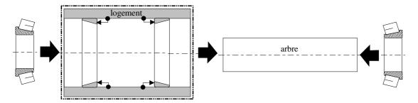
3° assurer les mises en position axiales, ♠, des 2 "cônes + cages" sur l'arbre ainsi que celle de l'ensemble "logement+2 cuvettes" et régler à l'extérieur du montage le jeu de fonctionnement (ou la précontrainte) sur une grande face d'un cône, ♠
