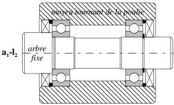
*Remarque :* utiliser les dispositifs de maintiens en position dans le logement **et** sur l'arbre. plus particulièrement :
