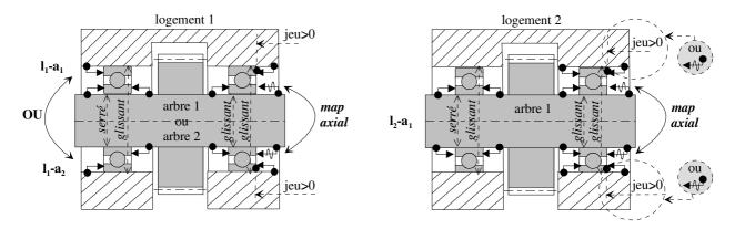
Le phénomène de laminage peut être alors éliminé en remplaçant cet ajustement serré par un map axial efficace
