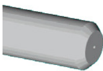
pièce à fileter : cylindre de révolution chanfreiné
