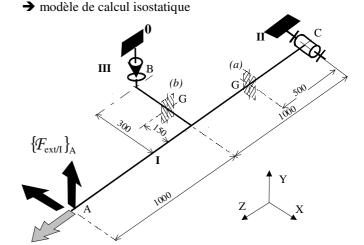
→ application du principe fondamental de la statique
