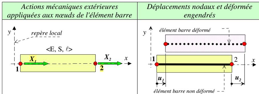
Le chargement de cet élément consiste en des forces  $X_1 \vec{x}$  au nœud (1) et  $X_2 \vec{x}$  au nœud (2). Les degrés de liberté associés sont donc les déplacements  $u_1 \vec{x}$  au nœud (1) et  $u_2 \vec{x}$  au nœud (2), soit au total deux d.d.l. pour l'élément.
