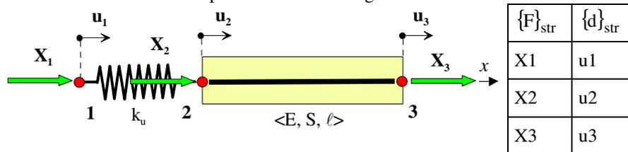
Les matrices de raideur de l'élément ressort hélicoïdal et de l'élément barre sont connues (voir ex. d'application) ainsi que les expressions des énergies potentielles de déformation correspondantes.
