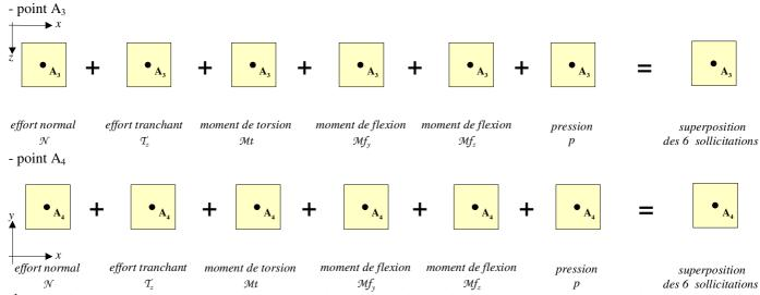
◆ construire les 4 cercles de Möhr résultant et déterminer les contraintes principales et la contrainte tangentielle maximale,
