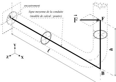
◆ Torseur des actions transmissibles de l'extérieur sur le tronçon FA exprimé au point A
