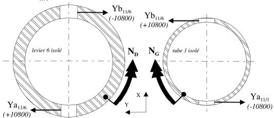
Cette modélisation des forces de contact se ramène à deux couples de forces de part et d'autre des zones éventuelles de rupture sur la goupille.
