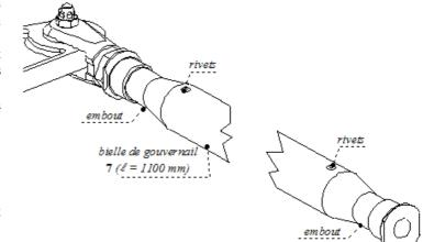
Dans ce cas, la distribution des contraintes est complexe et on se limite à un calcul simple de la contrainte tangentielle moyenne pour vérifier la condition de résistance :
