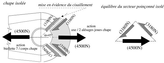
♦ torseur de cohésion au centre géométrique de la section poinçonnée inférieure de la chape
