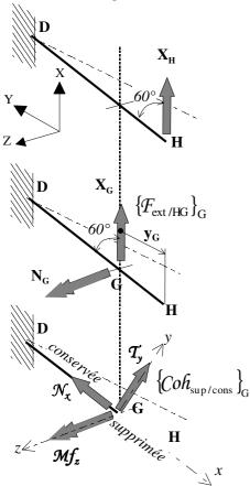
• Torseur des actions transmissibles de l'extérieur sur le tronçon HG exprimé au point G (on pose  $\overrightarrow{GH} = x_G \overrightarrow{X} + y_G \overrightarrow{Y}$  avec  $x_G < 0$  et  $y_G < 0$ )
