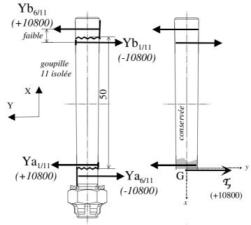
Pour obtenir une sollicitation de cisaillement seule, dans le modèle de calcul la distance entre les supports des forces situées de part et d'autre de la zone de rupture doit être faible (suppression des effets de flexion).
