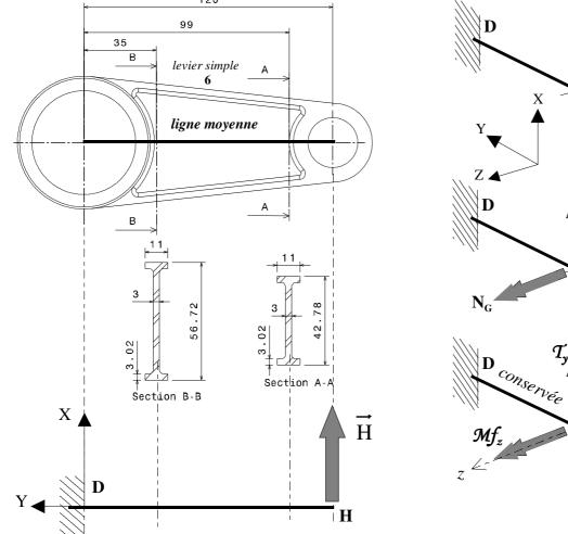
• Torseur des actions transmissibles de l'extérieur sur le tronçon HG exprimé au point G (on pose  $\overrightarrow{GH} = y_G \overrightarrow{Y}$  avec  $y_G < 0$ )
