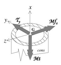
→ Diagrammes des évolutions des éléments de réduction du torseur de cohésion dans le tube (efforts extérieurs dans un plan parallèle à XZ)
