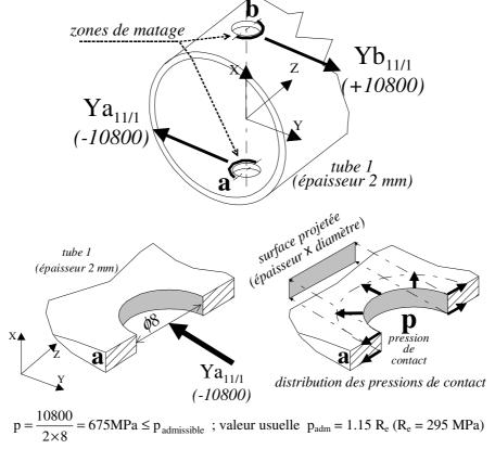
C'est une valeur élevée de pression de contact, il y a matage (déformation permanente) dans l'alésage \$\phi\$8 du tube 1 au contact de la goupille 11. Pour éviter ce mode de détérioration il conviendrait de mettre deux goupilles coniques décalées axialement et disposées orthogonalement (solution aéronautique très utilisées garantissant la sécurité, le fail safe ou redondance des solutions)
