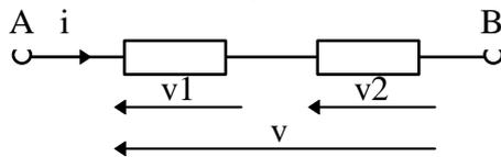
Soit le montage ci-contre associant en série deux dipôles quelconques, avec  $v_1(t)$ ,  $v_2(t)$  et  $i(t)$  de même période.
