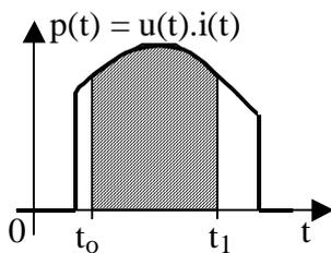
➤ **Sur l'intervalle**  $[t_0, t_1]$ , l'énergie électrique échangée est donc la somme des énergies élémentaires échangées sur tous les intervalles «  $dt$  » successifs qui constituent cet intervalle  $[t_0, t_1]$ .
