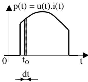
➤ **Sur un intervalle infiniment petit** : «  $dt$  »,  $u(t)$  et  $i(t)$  restent quasiment constants. On peut donc appliquer l'expression de l'énergie électrique en courant continu. Cette énergie étant infiniment petite, elle sera désignée par «  $dw$  ».
