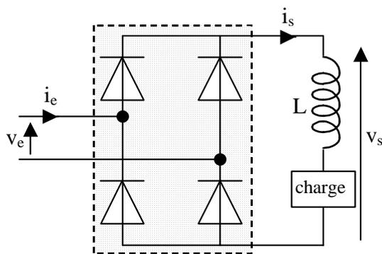
Un pont redresseur à diodes, alimenté sous une tension alternative sinusoïdale  $v_e(t)$  applique une tension redressée  $v_s(t)$  à une charge très inductive (5). En régime permanent, le courant  $i_s(t)$  est quasiment constant :  $i_s(t) \approx I_o = \text{constante}$ .
