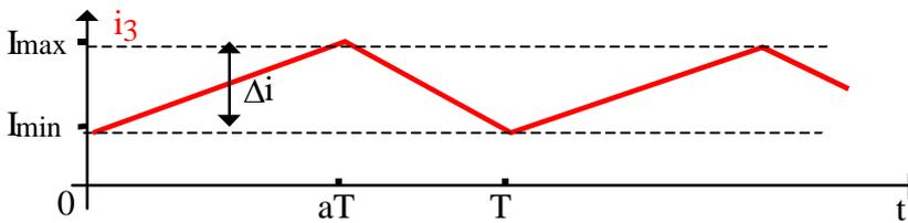
c) Calculer  $I_{3_{eff}}$  en fonction de  $I_{min}$ ,  $a$  et  $\Delta i$ .
