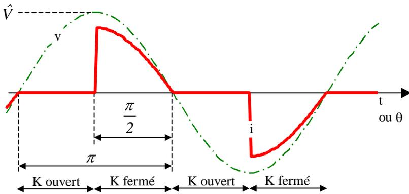
Le courant qui traverse le dipôle est constitué de morceaux de fonction alternative sinusoïdale comme indiqué en gras sur le graphe ci-contre.
