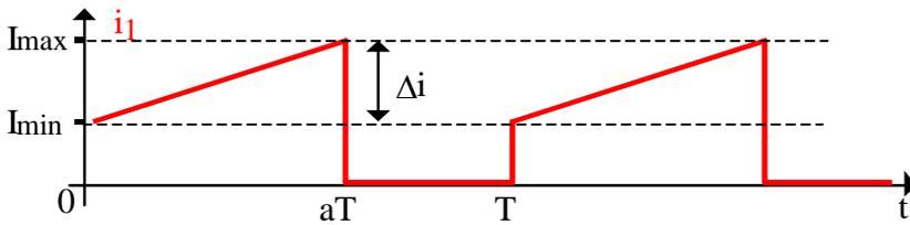
a) Calculer  $\langle I_1 \rangle$  et  $I_{1_{eff}}$  en fonction de  $I_{min}$ ,  $a$  et  $\Delta i$ .
