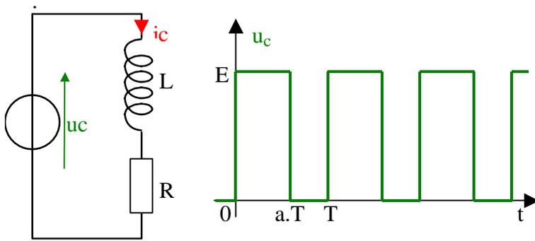
Un hacheur série appliqué à une résistance  $R$  en série avec une inductance  $L$ , la tension carrée  $u_c(t)$  d'amplitude «  $E$  » et de rapport cyclique «  $a$  ».
