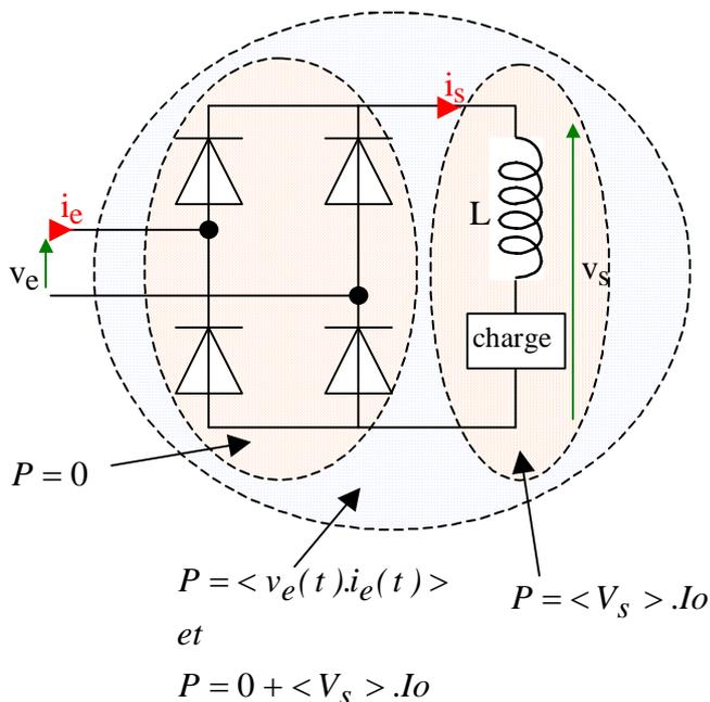
➤ Les diodes, si on les considère idéales, sont des composants qui se comportent soit comme des interrupteurs ouverts (courant nul), soit comme des interrupteurs fermés (tension nulle).
