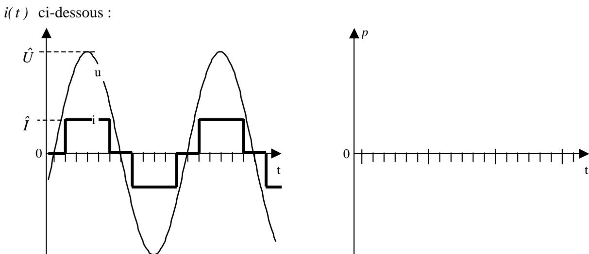
Représenter le graphe de la puissance instantanée  $p(t)$ . En déduire une estimation graphique de la puissance active « P » dans ce dipôle. Calculer « P ». *(Réponse 1:)*
