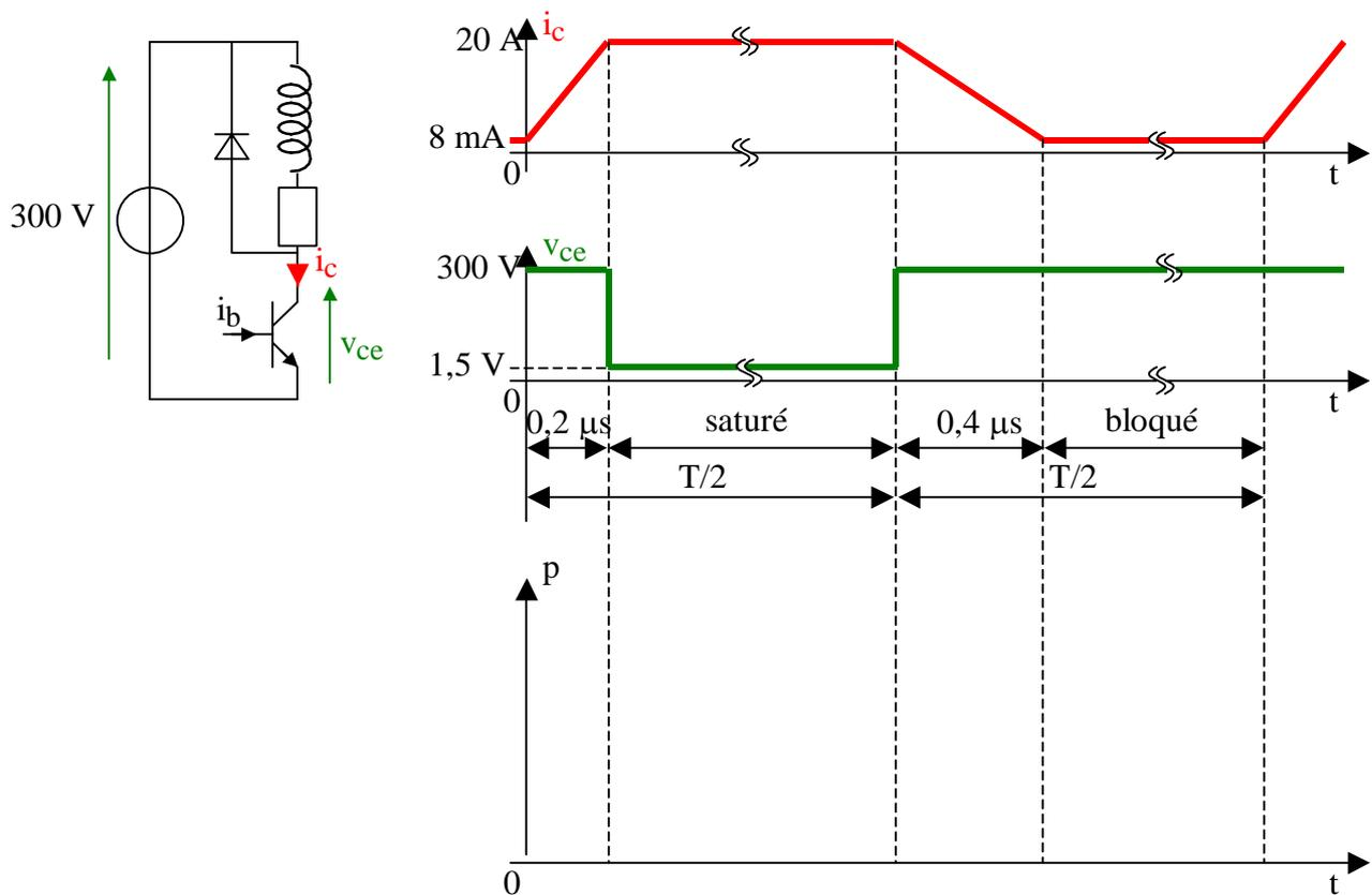
a) Représenter le graphe de la puissance instantanée  $p(t)$  dissipée dans le transistor.
