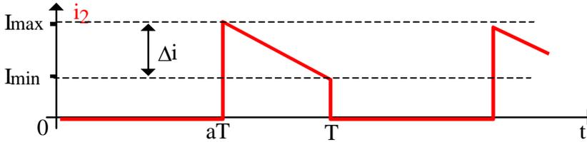
b) Calculer  $I_{2_{eff}}$  en fonction de  $I_{min}$ ,  $a$  et  $\Delta i$ . (Ce calcul est plus facile si on s'intéresse à l'intervalle  $[-T, 0]$ ).
