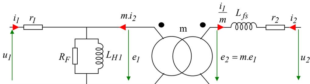
a) Par définition, le courant secondaire est nul « à vide », donc  $u_2(t) = m.e_1(t)$ . Le courant primaire à vide est faible par rapport au courant nominal (en charge « nominale »), donc pour un transformateur industriel usuel : à vide :  $u_1(t) = r_1.i_1(t) - e_1(t) \approx -e_1(t)$ .
