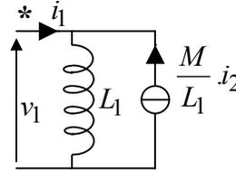
De même, on peut établir un schéma électrique équivalent au bobinage N°2 :
