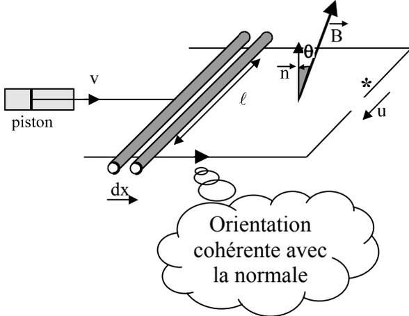
1) L'orientation de la spire est obtenue par la règle de la main droite ou du tire-bouchon.
