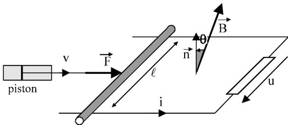
Le piston pousse le conducteur mobile avec une force  $\vec{F}$  de sorte que celui-ci se déplace toujours à la vitesse  $v$ .
