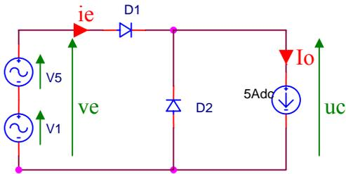
Le redresseur mono-alternance ci-contre est alimenté par une tension  $v_e(t)$  qui n'est pas alternative sinusoïdale. Cette tension peut être décrite par l'expression :  $v_e(t) = 100 \cdot \sin(100 \cdot \pi \cdot t) + 40 \cdot \sin(500 \cdot \pi \cdot t)$ . Il est chargé par une charge qui peut être modélisée par une source de courant constant  $I_o = 5 \text{ A}$ . Les diodes sont supposées **idéales**.
