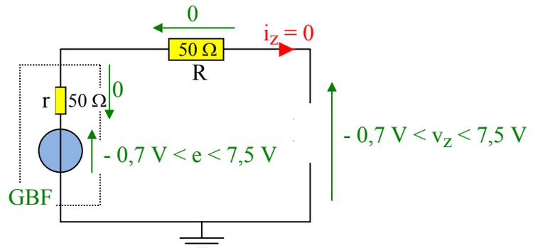
d) Si la diode zener est conductrice en inverse, le courant  $i_z$  est positif et donc  $e > 7,5 \text{ V}$  (loi des mailles)
