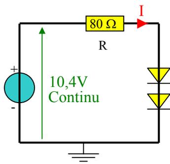
Les diodes ci-contre conduisent en direct. Chaque diode peut être modélisée par le modèle linéaire :  $E_o = 0,7V$  et  $r = 5\Omega$ .
