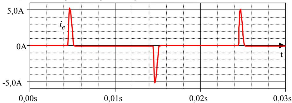
a) En régime périodique,  $v_{C1}(t) > 0$  et  $v_{C2}(t) > 0$ . Les deux diodes ne peuvent donc pas conduire en même temps. En observant le graphe de  $i_e(t)$ , indiquer (ci-contre) les intervalles de conduction de chaque diode.
