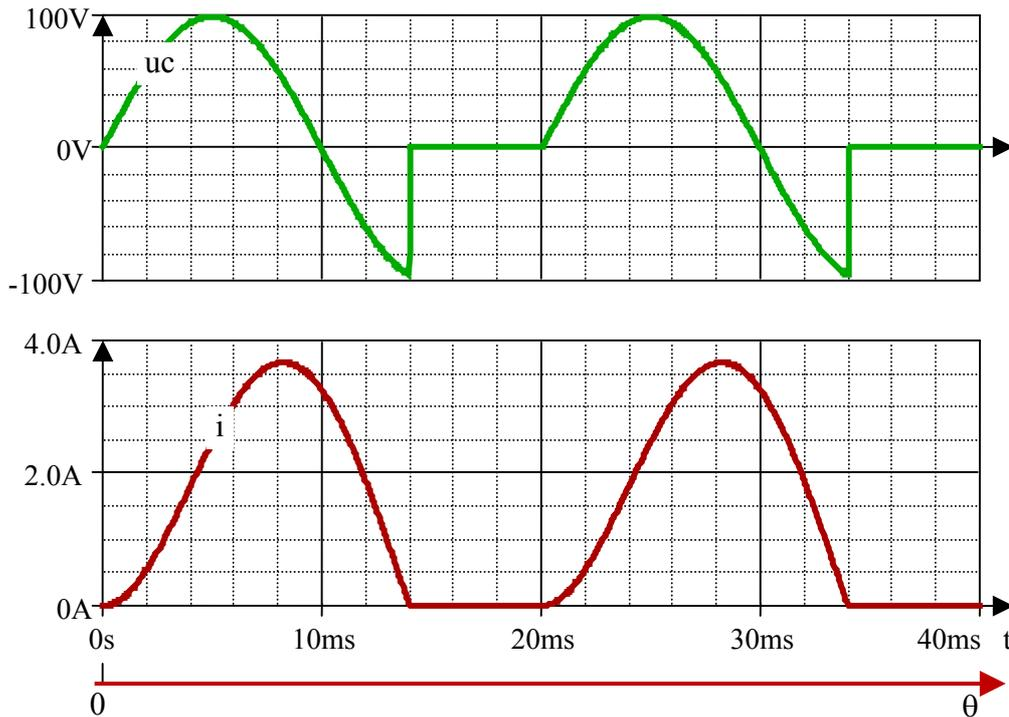
Une tension  $v(t) = 100 \cdot \sin(100 \cdot \pi \cdot t)$  est appliquée à un circuit inductif  $R, L$  en série avec une diode « D » (supposée idéale). L'inductance a une valeur de  $0,1\text{H}$ . La résistance « R » est inconnue
