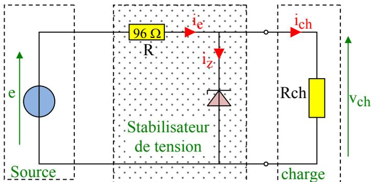
Le stabilisateur de tension à diode zener ci-contre débite dans une charge modélisée par une résistance  $R_{ch} = 400 \Omega$ .
