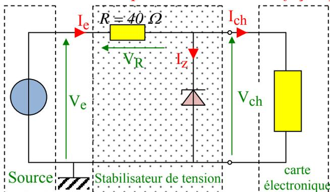
On dispose d'une source de tension constante  $V_e = 9\text{ V}$  à partir de laquelle on souhaite alimenter une carte électronique sous une tension constante  $V_{ch} = 5\text{ V}$  quelle que soit la valeur du courant consommé  $I_{ch}$ .
