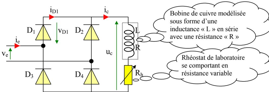
Le pont monophasé à diodes ci-contre est alimenté par une tension alternative sinusoïdale
