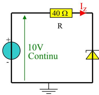
La diode zener ci-contre conduit en inverse. Elle peut être modélisée par le modèle linéaire :  $V_{zo} = 5,5V$  et  $r_z = 5\Omega$ .
