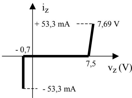
b) Allure de la caractéristique  $I_z$  en fonction de  $V_z$  pour un courant variant de  $-I_{z_{\max}}$  à  $+I_{z_{\max}}$  (ci-contre).
