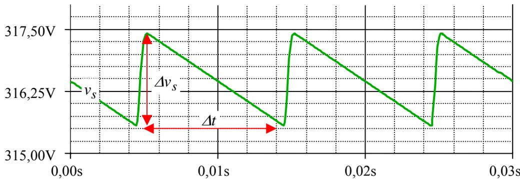
e) Sur l'intervalle  $\Delta t = 9 \text{ ms}$  pendant lequel  $i_e(t) = 0$ , l'ondulation de  $v_s(t)$  est  $\Delta v_s = 1,8 \text{ V}$ . (voir ci-contre)
