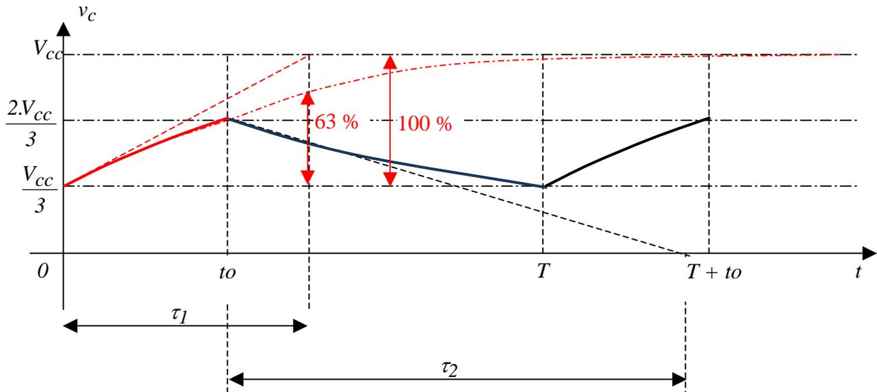
b) Déterminer l'expression analytique  $v_c(t)$  sur l'intervalle  $[0 ; t_0]$ . En déduire  $t_0$  en fonction de  $R_1$  et  $C$  : La constante de temps est  $\tau_1 = R_1.C$
