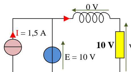
$t \rightarrow \infty$  Courant constant dans l'inductance  $\Rightarrow$  tension nulle à ses bornes  $\Rightarrow v = 10 \text{ V}$
