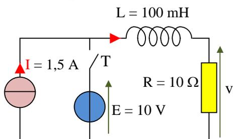
T : Interrupteur ouvert pour  $t < 0$  et fermé pour  $t > 0$ .
