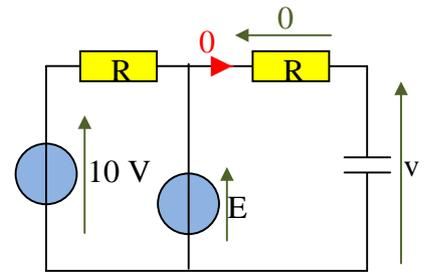
$t \rightarrow \infty$  Tension constante aux bornes du condensateur
