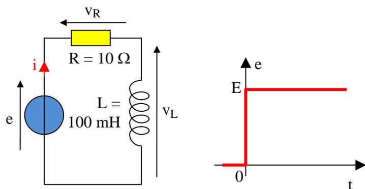
Soit le dipôle R.L série ci-contre alimenté par une source de tension  $e(t)$  produisant un échelon de tension  $E$  à partir de  $t = 0$ .
