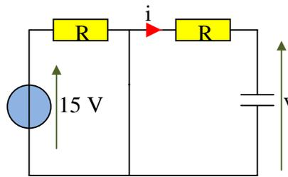
$t = 0^+$  Pas de discontinuité de la tension aux bornes du condensateur  $v = 15\text{ V}$
