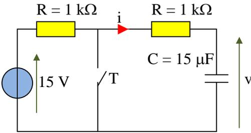
T : Interrupteur ouvert pour  $t < 0$  et fermé pour  $t > 0$ .
