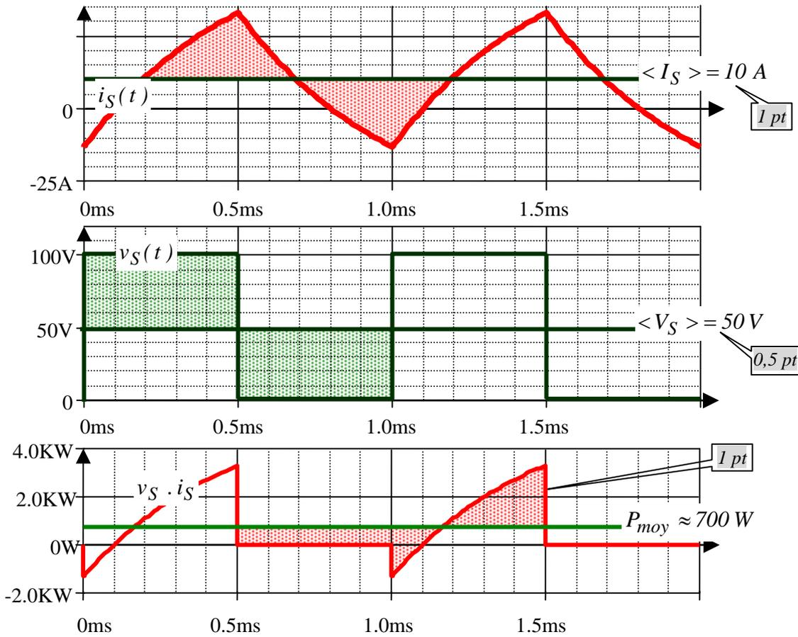
$$P = \frac{1}{T} \cdot \int_0^{\frac{T}{2}} U \cdot i_S(t) \cdot dt = \frac{1}{10^{-3}} \cdot \int_0^{5 \cdot 10^{-4}} 100 \cdot \left[ (-73,1) e^{-\frac{t}{5 \cdot 10^{-4}}} + 60 \right] \cdot dt = \dots = 689,6 \text{ W}$$
