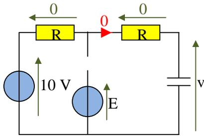
$t < 0$  : Tension constante aux bornes du condensateur
