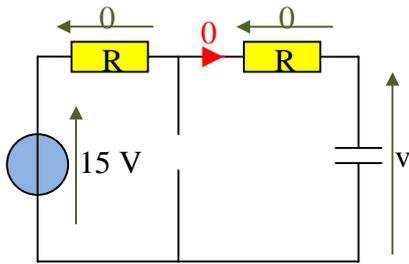
$t < 0$  : Tension constante aux bornes du condensateur
