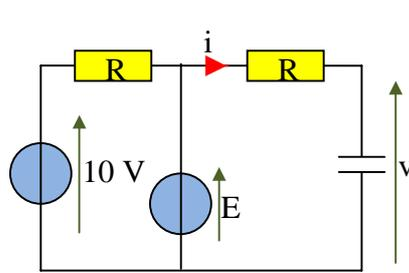
$t = 0^+$  Pas de discontinuité de la tension aux bornes du condensateur  $v = 15 \text{ V}$
