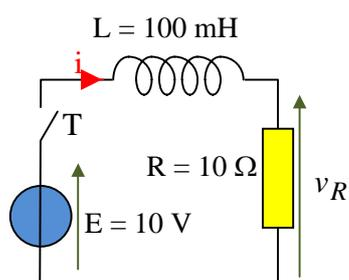
T : Interrupteur ouvert pour  $t < 0$  et fermé pour  $t > 0$ .
