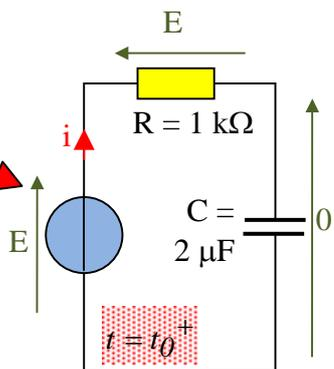
Pas de discontinuité de la tension aux bornes du condensateur
