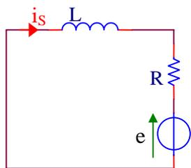
Le circuit ci-contre est constitué d'une résistance  $R = 2 \Omega$ , d'une inductance  $L = 2 \text{ mH}$  et d'une source de tension (orientée dans le sens de la flèche) dont la valeur est  $E = 40 \text{ V}$  lorsque  $t > t_0$  (avec  $t_0 = 0,5 \text{ ms}$ ).
