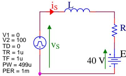
Les graphes ci-dessous sont obtenus à l'aide d'une simulation sous Pspice ® avec le montage ci-contre.  $v_S(t)$  est un signal carré d'amplitude 100 V (voir ci-dessous) et  $E$  est une source de tension continue de valeur 40 V.
