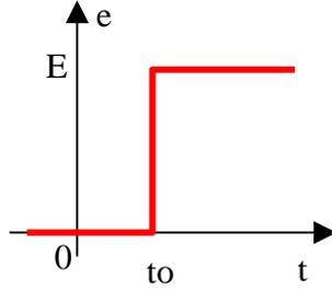
Soit le dipôle R.C série ci-contre alimenté par une source de tension  $e(t)$  produisant un échelon de tension  $E = 10 \text{ V}$  à partir de l'instant  $t_0 = 2 \mu\text{s}$ .
