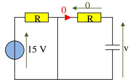
$t \rightarrow \infty$  Tension constante aux bornes du condensateur
