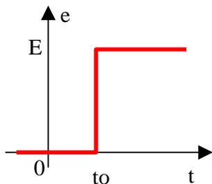
Soit le dipôle R.C série ci-contre alimenté par une source de tension  $e(t)$  produisant un échelon de tension  $E = 10 \text{ V}$  à partir de l'instant  $t_0 = 2 \text{ ms}$ .
