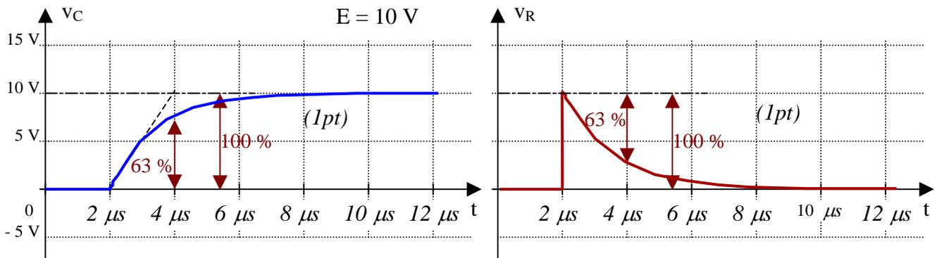
$$v_C(t) = (0 - E).e^{-\frac{t-t_0}{R.C}} + E \quad (1pt); \quad v_R(t) = (E).e^{-\frac{t-t_0}{R.C}} \quad (1pt) \text{ avec les valeurs numériques : } E = 10 \text{ V},$$
