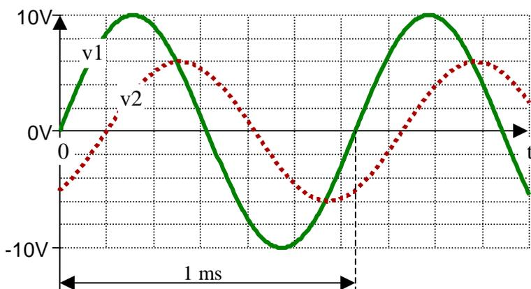
$$v_1(t) = 10 \cdot \sin(\omega t) \text{ ou } v_1(t) = 10 \cdot \cos\left(\omega t - \frac{\pi}{2}\right) \quad \boxed{0,5 \text{ pt}}$$
