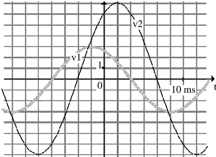
Après avoir dessiné à main levée les vecteurs de Fresnel associés à  $v_1(t)$  et  $v_2(t)$ , estimer l'amplitude de la somme:  $v(t) = v_1(t) + v_2(t)$ .
