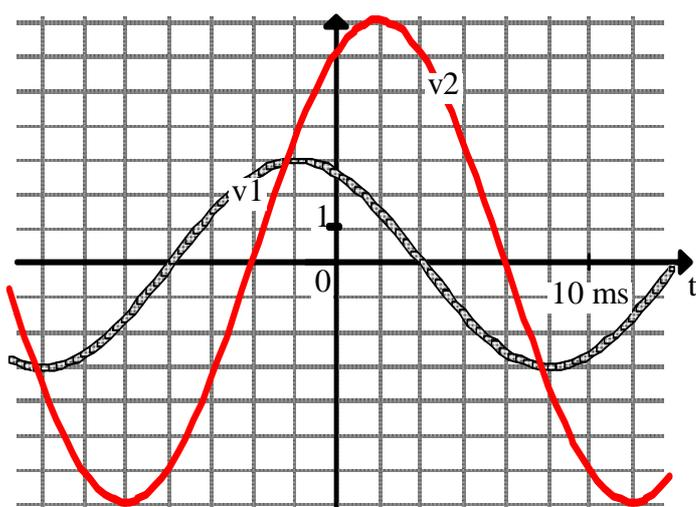
Soient deux fonctions alternatives sinusoïdales  $v_1(t)$  et  $v_2(t)$  dont les graphes sont donnés ci-contre. A la fonction  $v_1(t)$  on a associé le vecteur de Fresnel suivant.
