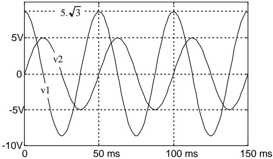
Déterminer les expressions analytiques de  $v_1(t)$  et de  $v_2(t)$
