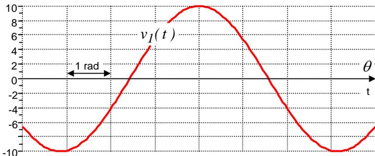
Le graphe ci-contre est celui de la fonction  $v_I(t) = 10.\sin(2000.\pi.t - 1,5)$ . Placer l'axe des ordonnées au point  $t = 0$ . (attention sinus !) Préciser la valeur de la période en ms:
