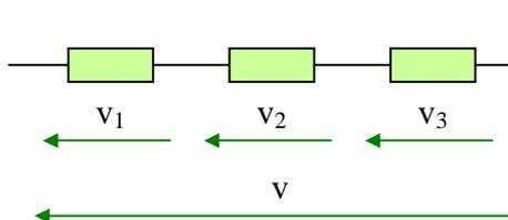
Sachant que  $v_1(t) = 10.\cos(\omega.t)$ ,  $v_2(t) = 15.\cos\left(\omega.t + \frac{\pi}{3}\right)$  et
