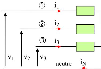
Un câble « triphasé » comporte quatre conducteurs de cuivre (notés ①, ②, ③ et neutre). Chaque conducteur a une section de 2,5 mm<sup>2</sup>. Il peut délivrer un courant alternatif sinusoïdal d'amplitude maximale 28 A sans que son échauffement (par effet Joule) ne soit excessif.
