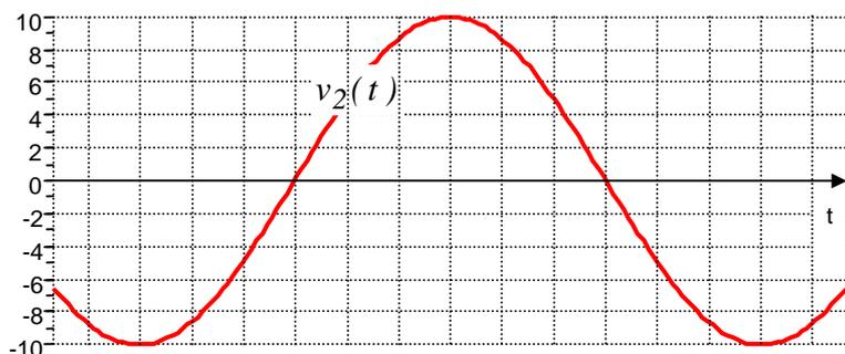
Le graphe ci-contre est celui de la fonction  $v_2(t) = 10.\sin\left(2000.\pi.t - \frac{\pi}{2}\right)$ . Placer l'axe des ordonnées au point  $t = 0$ . (*attention sinus !*) Préciser la valeur de la période :
