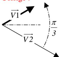
$$v_2(t) = 7 \cdot \cos\left(\omega t - \frac{\pi}{6}\right) \text{ avec } \omega = \frac{2\pi}{\text{période}} = \frac{2\pi}{20 \cdot 10^{-3}} = 100\pi \text{ rad / s}$$
