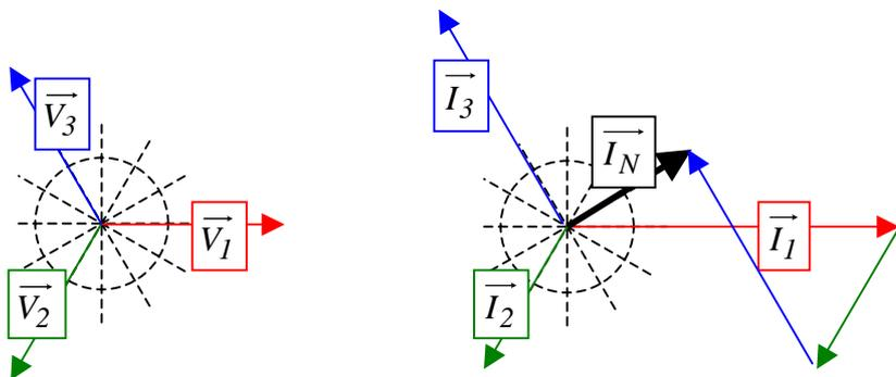
a) Les courants  $i_1(t)$ ,  $i_2(t)$  et  $i_3(t)$  sont respectivement en phase avec les tensions  $v_1(t)$ ,  $v_2(t)$  et  $v_3(t)$ . Le diagramme de Fresnel à main levée montre que l'amplitude du courant  $i_N(t)$  est inférieure à 10 A
