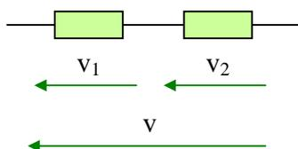
$v_1(t) = 10.\cos(\omega.t)$  et  $v_2(t) = 15.\cos(\omega.t + 1)$ , ( $1 \text{ rad} \leq 60^\circ$ )
