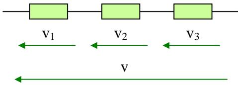
Sachant que  $v_1(t) = 10.\cos(\omega.t)$  ,  $v_2(t) = 15.\cos(\omega.t + 1)$  et  $v_3(t) = 20.\cos(\omega.t - 0.5)$ .
