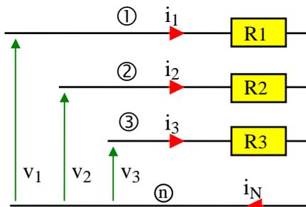
a) Ce câble est alimenté par trois tensions  $v_1(t)$ ,  $v_2(t)$  et  $v_3(t)$  représentées ci-dessous **aux bornes** des trois résistances  $R_1$ ,  $R_2$  et  $R_3$  ci-contre.
