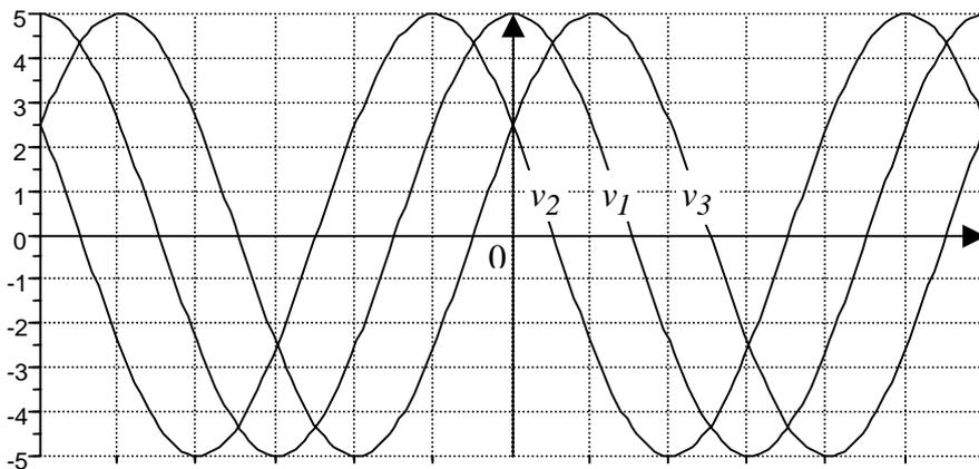
Soient  $v_1(t)$  ,  $v_2(t)$  et  $v_3(t)$  trois tensions alternatives sinusoïdales représentées ci contre. On étudie le montage suivant :
