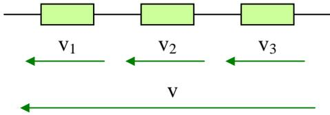
Sachant que  $v_1(t) = 10.\cos(\omega.t)$  ,  $v_2(t) = 15.\cos\left(\omega.t + \frac{\pi}{2}\right)$  et  $v_3(t) = 30.\cos\left(\omega.t - \frac{\pi}{6}\right)$ , **estimer** l'expression analytique de  $v(t)$  à l'aide d'un diagramme de Fresnel.
