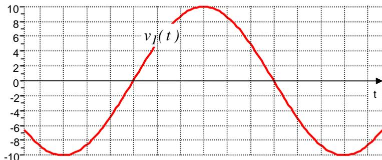
Le graphe ci-contre est celui de la fonction  $v_1(t) = 10.\cos\left(100.\pi.t + \frac{\pi}{3}\right)$ . Placer l'axe des ordonnées au point  $t = 0$ . Préciser la valeur de la période :
