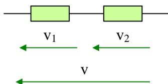
Sachant que  $v_1(t) = 10.\cos(\omega.t)$  et  $v_2(t) = 15.\cos(\omega.t - 1)$ , **estimer** l'expression analytique de  $v(t)$  à l'aide d'un diagramme de Fresnel à main levée. ( $1 \text{ rad} = 57,3^\circ$ )
