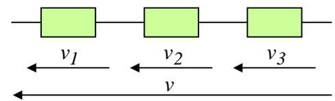
A l'aide d'un diagramme de Fresnel, estimer l'amplitude  $V_{max}$  de la tension  $v(t)$  et son déphasage  $\varphi$  par rapport à  $v_1(t)$ . Préciser quels sont les vecteurs  $\vec{V}_1$  ,  $\vec{V}_2$  ,  $\vec{V}_3$  et  $\vec{V}$
