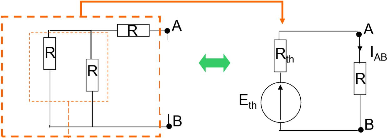
On retire la résistance de charge
