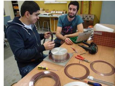
Assemblage d'un stator dans le cadre d'un projet de DUT
