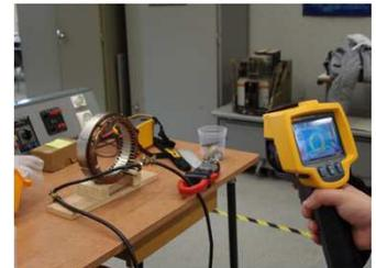
Caractérisation thermique des soudures du bobinage
