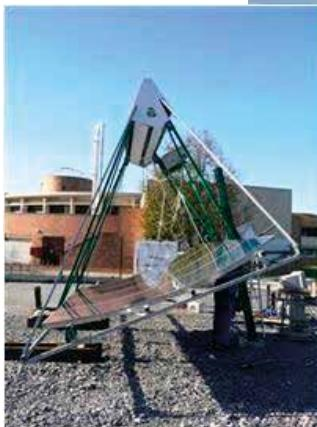
Fig. 3 : Photographie du capteur solaire à concentration.
