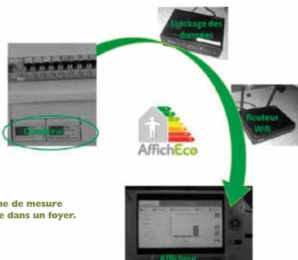
La chaîne de mesure installée dans un foyer.
